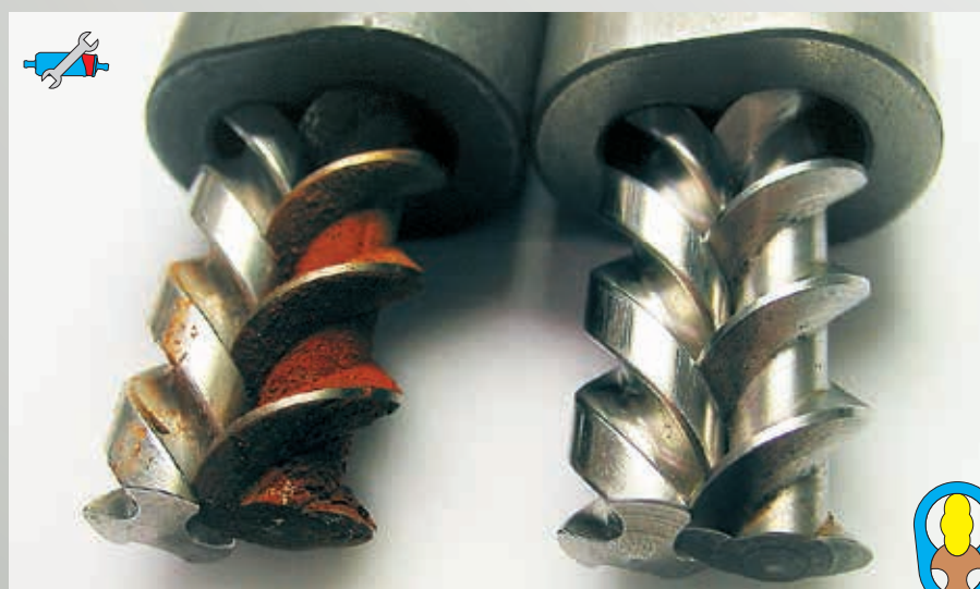
Рис. 54: Витовой насос (слева — заржавевший, а справа — новый)
