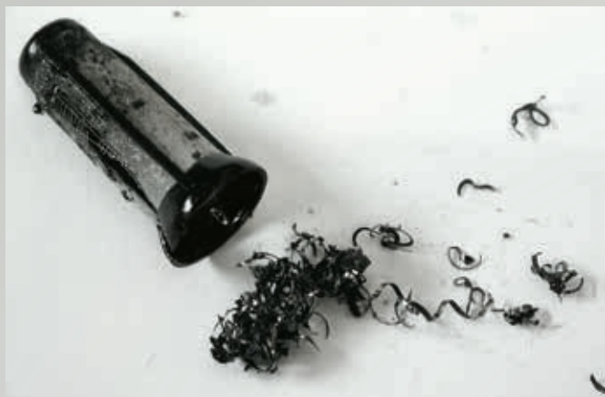
Рис. 29: Опилки в сетчатом фильтре Здесь металлические опилки попали в топливный бак при работах на топливной системе. Опилки с острыми краями повредили сетчатый фильтр. Из-за этого грязь может проникнуть в насос и заблокировать насосный механизм.
