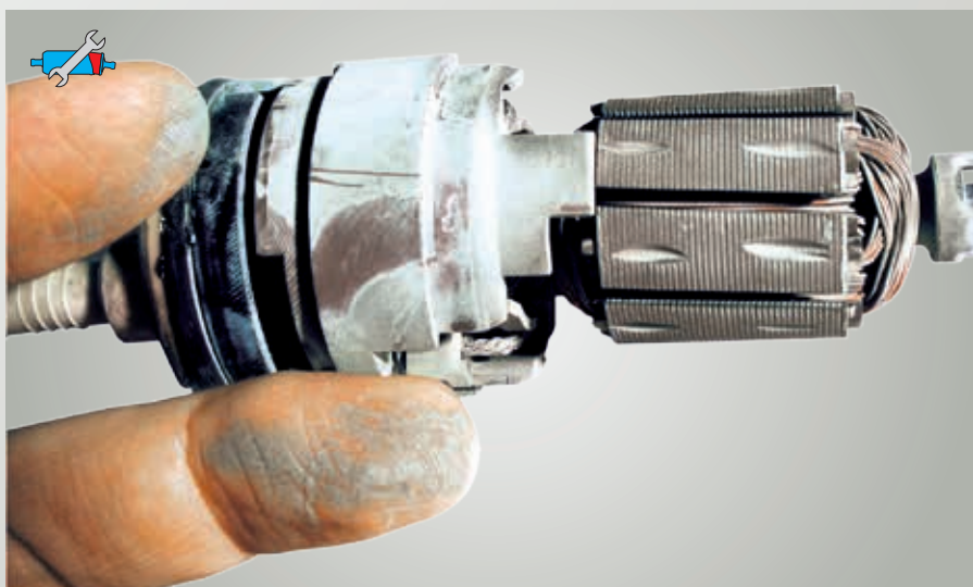
Рис. 56: Отложения из-за топлива недостаточного качества
