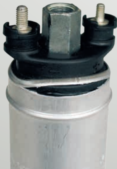
Рис. 1: Повреждение от воздействия силы Не всегда повреждение так очевидно.
