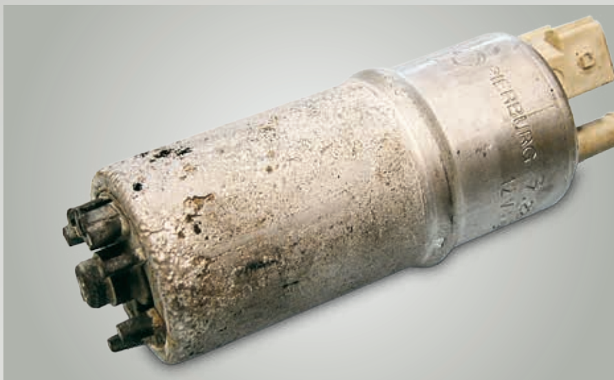
Рис. 72: Контактная коррозия из-за неподходящего сочетания материалов
