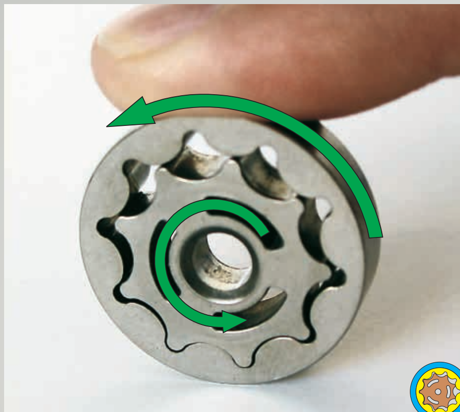
Рис. 52: Части трохоидного насосного механизма должны легко вращаться.
