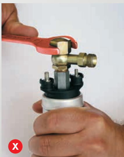
Рис. 70: Неправильный монтаж: затягивание без стопорения
