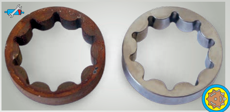
Рис. 48: Слева: сильно заржавевшее трохоидное зубчатое кольцо; справа: в новом состоянии
