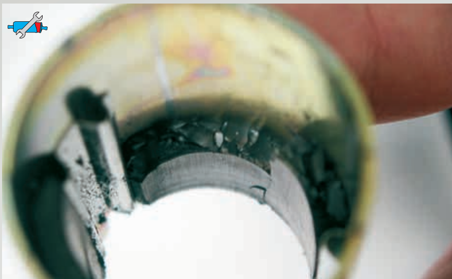
Рис. 80: Разбитый постоянный магнит (статор)
