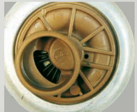
Рис. 35: Для сравнения: взгляд во всасывающий патрубок лопастного насоса с боковым каналом с неповрежденным рабочим колесом.
