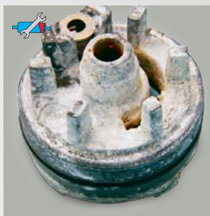
Рис. 50: Заизвесткованный наружный подшипник топливного насоса
