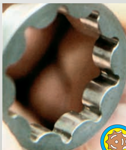
Рис. 51: Трохоидное зубчатое кольцо (слева с известковыми отложениями, справа — новое)
