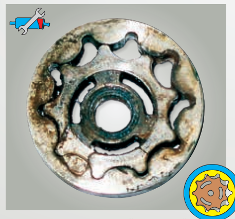
Рис. 19: Блокированный насосный механизм (трохоидное зубчатое кольцо) шестеренчатого насоса ЕЗТ
