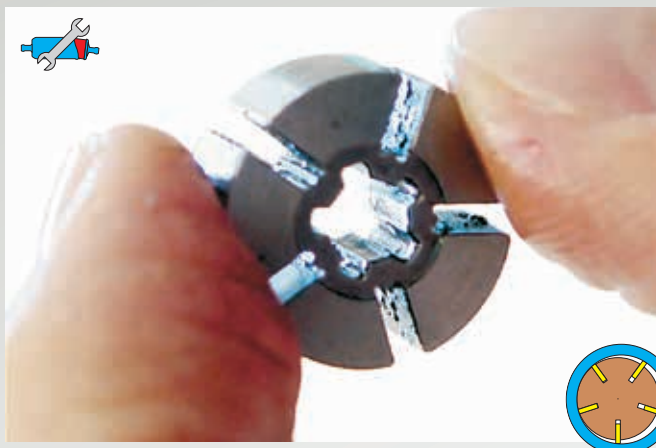
Рис. 30: Загрязненный насосный механизм шибберного пластинчатого насоса Ротор так загрязнен, что отдельные пластины (здесь удалены) больше не могут двигаться. Насос хотя еще и «работает», но больше не качает.
