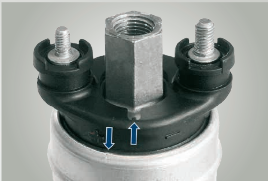
Рис. 69: Смещенная крышка насоса На топливных насосах типов E2T и E3T нанесены маркировки. Данные маркировки должны находиться друг против друга. Если это не так, то с насосом неправильно обращались и тем самым повредили его.
