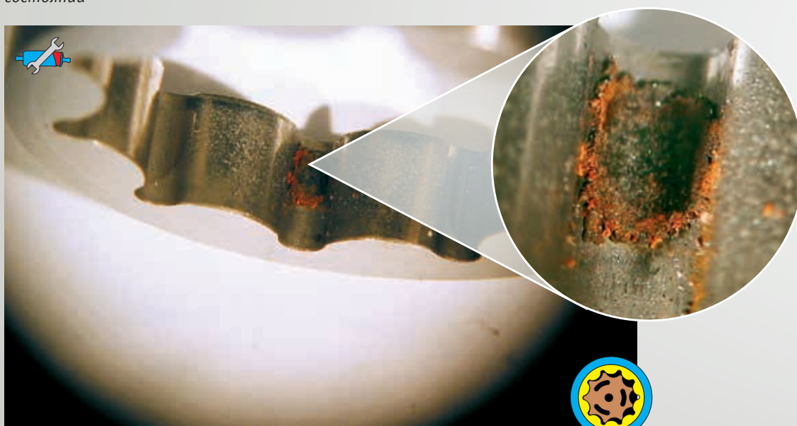
Рис. 47: Трохоидное зубчатое кольцо блокируется частицами ржавчины
