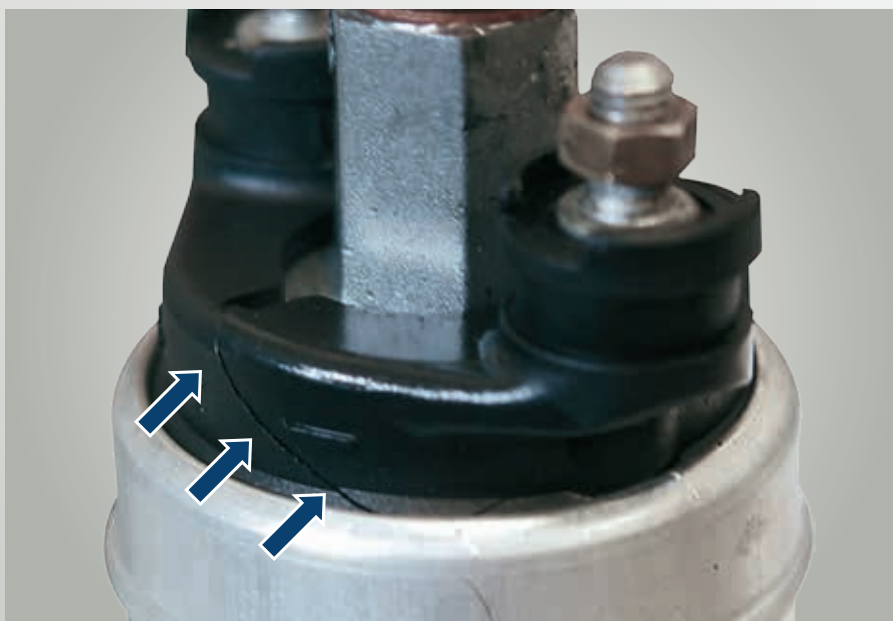
Рис. 73: Повреждение от воздействия силы на корпус
