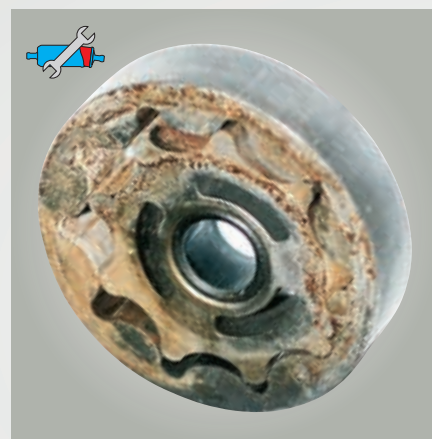
Рис. 53: Для сравнения: заржавевший трохоидный насосный механизм. Здесь больше ничего не двигается.
