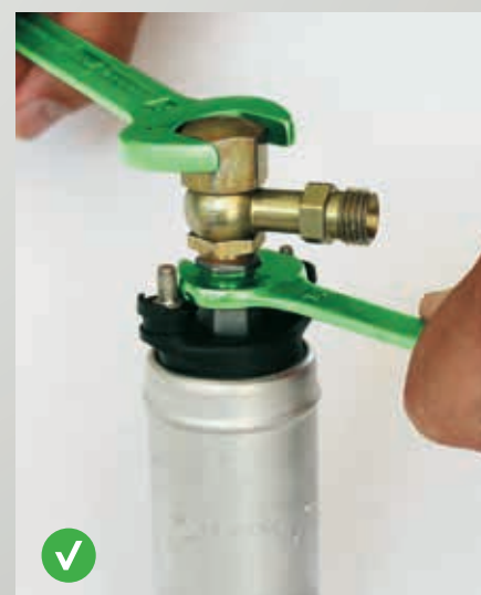
Рис. 71: Правильный монтаж: нижний шестигранник топливного насоса необходимо застопорить.
