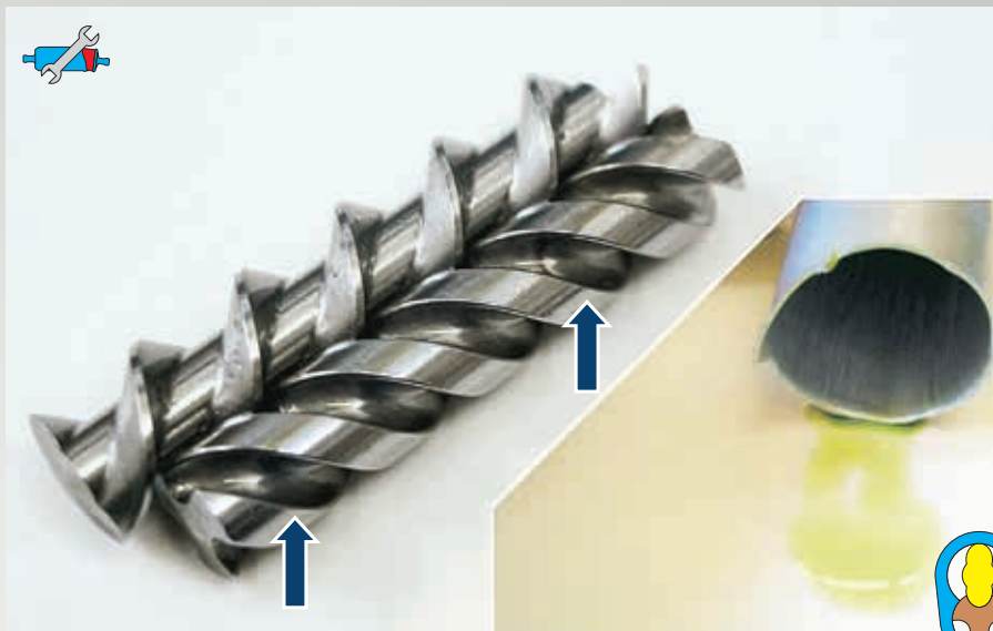
Рис. 55: Склеивания из-за недопустимой среды
