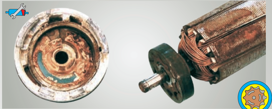
Рис. 37: Шестеренчатый насос E3T – с отложениями ржавчины и извести
