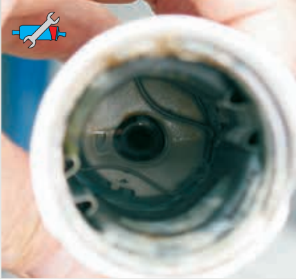
Рис. 44: Вода в топливном насосе
