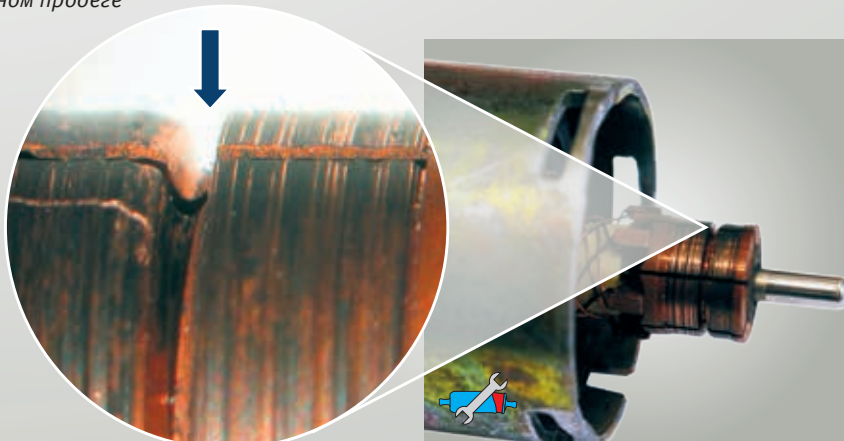
Рис. 62: Скользящие контакты при пробеге ок. 15 000 км. Слева: преждевременно изношенные; справа: нормальное состояние при данном пробеге
