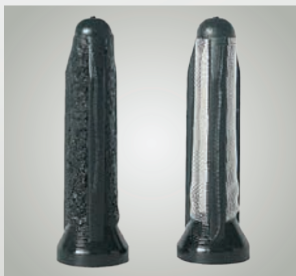
Рис. 22: Сетчатый фильтр шибера насоса E1F: слева забит — справа новый
