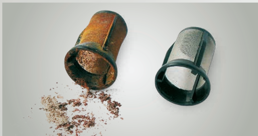
Рис. 41: Забитый ржавчиной сетчатый фильтр; справа: новый сетчатый фильтр
