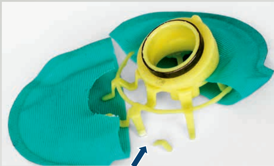
Рис. 76: Отломанные ребра жесткости в фильтре насоса In-Tank
