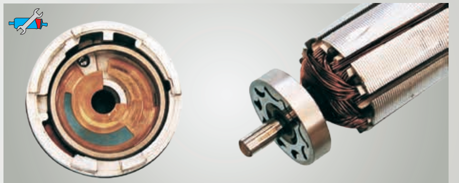
Рис. 38: Для сравнения: шестеренчатый насос E3T – в хорошем состоянии, несмотря на большой пробег
