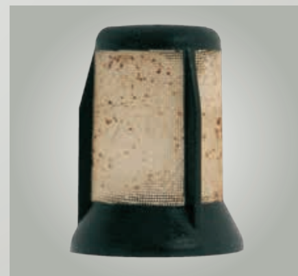
Рис. 23: Загрязненный сетчатый фильтр шестеренчатого насоса E3T
