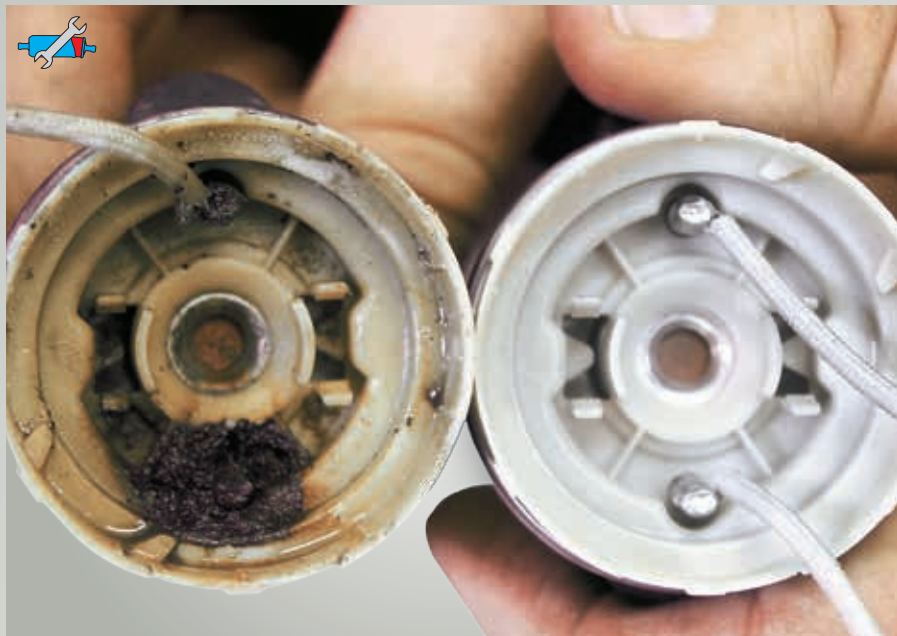
Рис. 46: Слева: корродированные электрические контакты; справа: в новом состоянии
