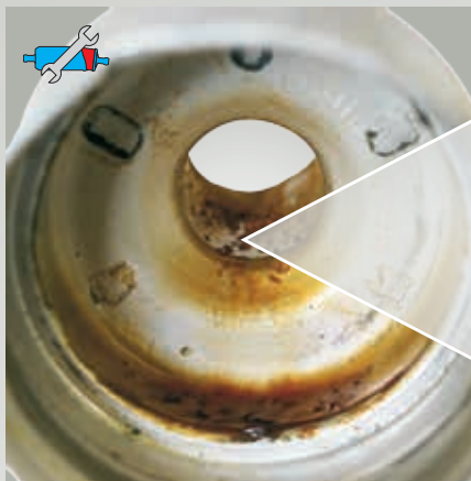
Рис. 64: Кристаллические отложения под действием недопустимой среды Что является причиной таких отложений, можно установить в отдельных случаях только путем сложных химических анализов.
