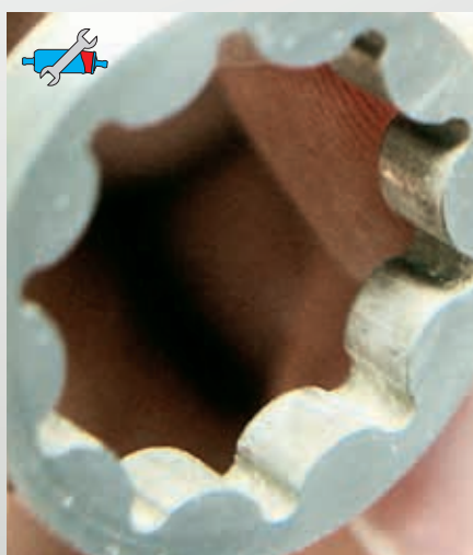
Рис. 51: Трохоидное зубчатое кольцо (слева с известковыми отложениями, справа — новое)
