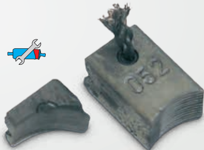
Рис. 62: Скользящие контакты при пробеге ок. 15 000 км. Слева: преждевременно изношенные; справа: нормальное состояние при данном пробеге
